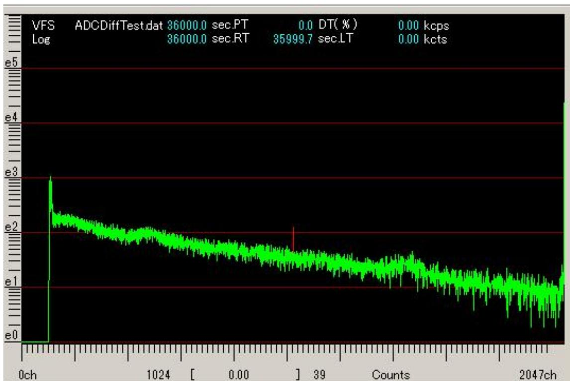
統計誤差のスペクトルと比較して下さい。このスペクトルではカウント数が多く成っても、ある時点からスペクトルの幅が太いままになっています。数ベクレルの測定には使用できません。微分非直線性とはMCA固有の誤差で検出下限が統計誤差(測定時間を長くしても)よりも大きい場合にはMCA固有の微分非直線性で検出下限が頭打ちに成ってしまいます。微分非直線性が理解しにくく、見落とすのは、統計誤差の測定で使用したMCAとこの微分非直線性の悪いMCAでCs-137の分解能を測定した場合スペクトルの形も分解能も殆ど見分けが付きません。さらにデータスムースを掛けたり、少ないch数のMCA(512ch)の場合は見かけ上線幅が狭くなります。
