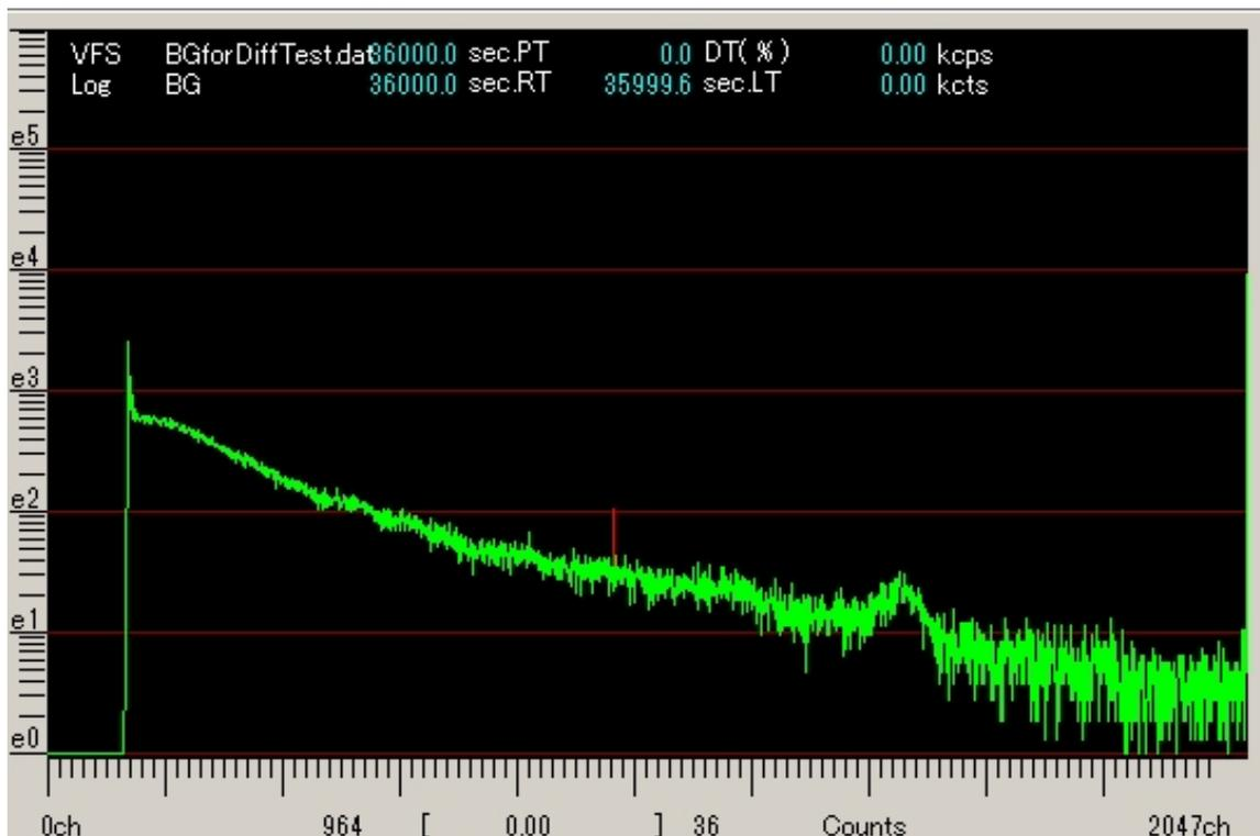
スペクトルの縦軸はLOG表示です。統計誤差を端的に表示しています・高エネルギー側のカウントの少ない所ではスペクトルの幅が広く(0?10カウントの間で激しく上下に変動しています。)低エネルギー側では200KeV近辺で500カウント程度ですが、スペクトルの幅が狭く線で描いた様になっています。統計的な誤差(カウントの変動)はエネルギーには関係なくスペクトルの線幅(カウントの変動)で表現できます。数ベクレルの測定には長時間測定しないといけないと言うよりは単位時間当たりのカウント(cpm、cps等)が少なくポツン、ポツンとしか検出されないので目標とする積算値まで到達するのに長時間かかると考えた方が妥当かもしれません。検出下限などもピークが有ると解る為にはスペクトルの線幅の3倍は盛り上がった時、線の上にポツンと頭を出すので検出できると表現できます。
