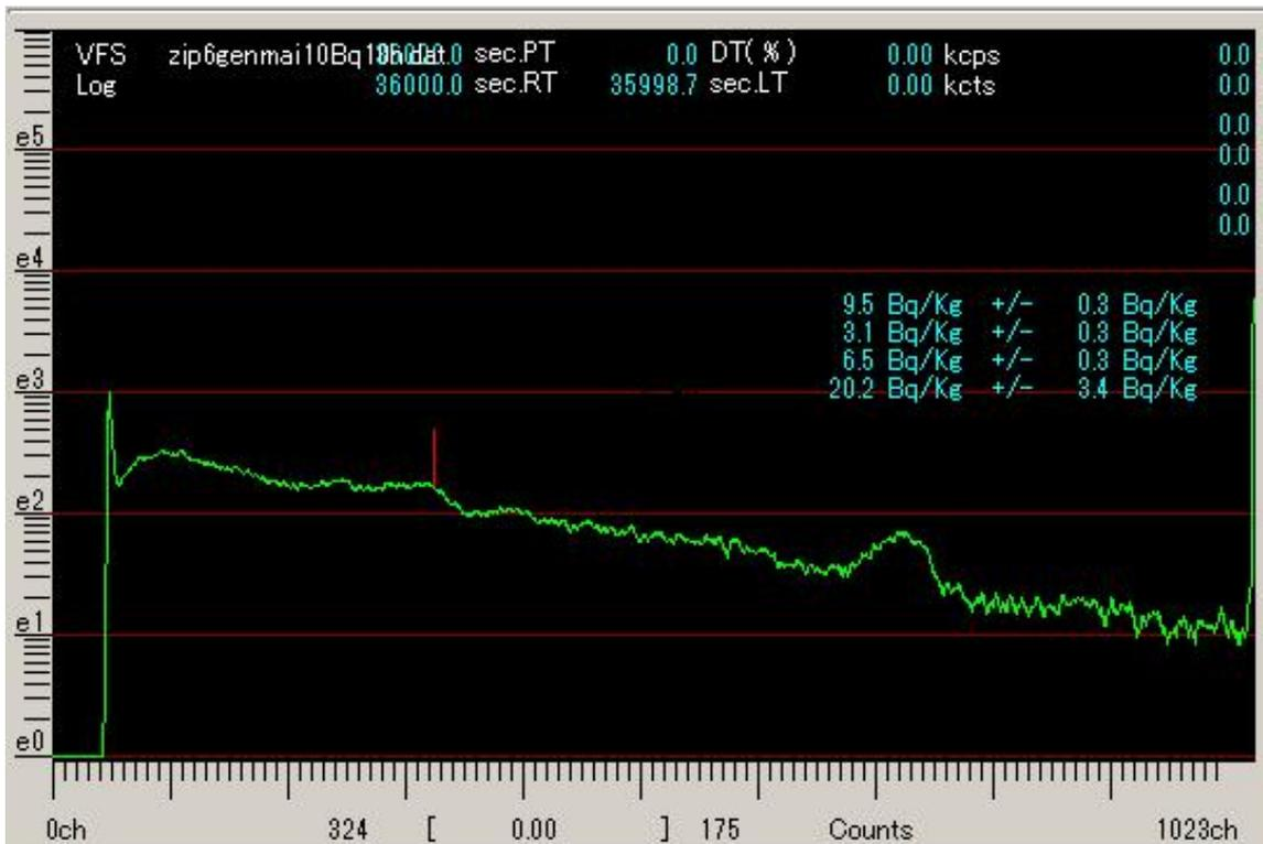
下記のスペクトルは、分析する試料の測定時間よりも、長い時間測定したBGスペクトルを試料の測定時間に合わせてノーマライズしたBGスペクトル(下図の茶色)重ね合わせて表示したものです。LOG表示の場合。
