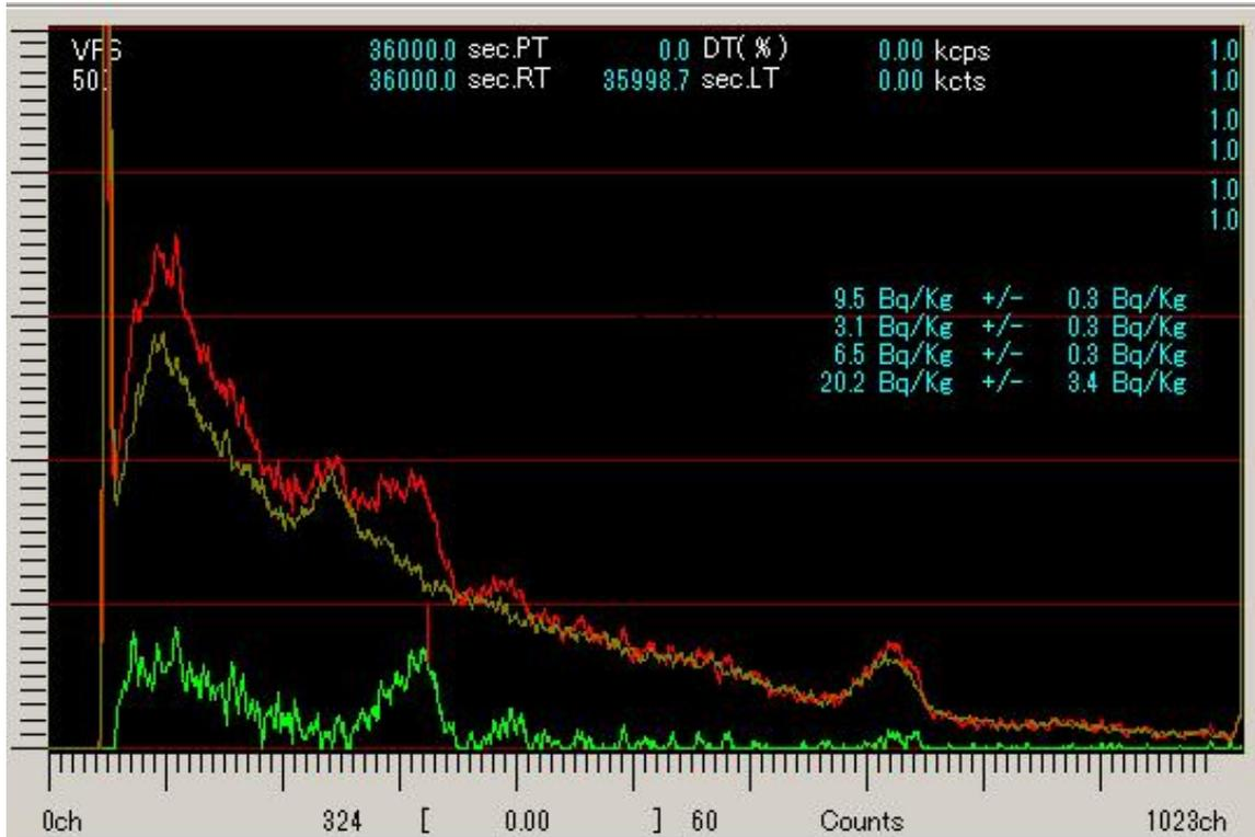
検出器の効率、検出器のサイズが大きく、試料の量が多い方が良くなりますがBGの方も検出器のサイズ、試料の量と共に増加してBGを押し上げ検出下限が悪くなります。鉛の遮蔽体も重くなります。iFKR-ZIPの独特な試料室の形状や2インチx2インチx1インチの扁平な検出器は、最大の検出効率で最小のBGを得るためにシミュレーションを繰り返した結果です。鉛4cm厚で総重量50Kgです。従来のNaI(Tl)検出器を使用した場合は、遮蔽体の総重量は150Kg程度が必要になります。
