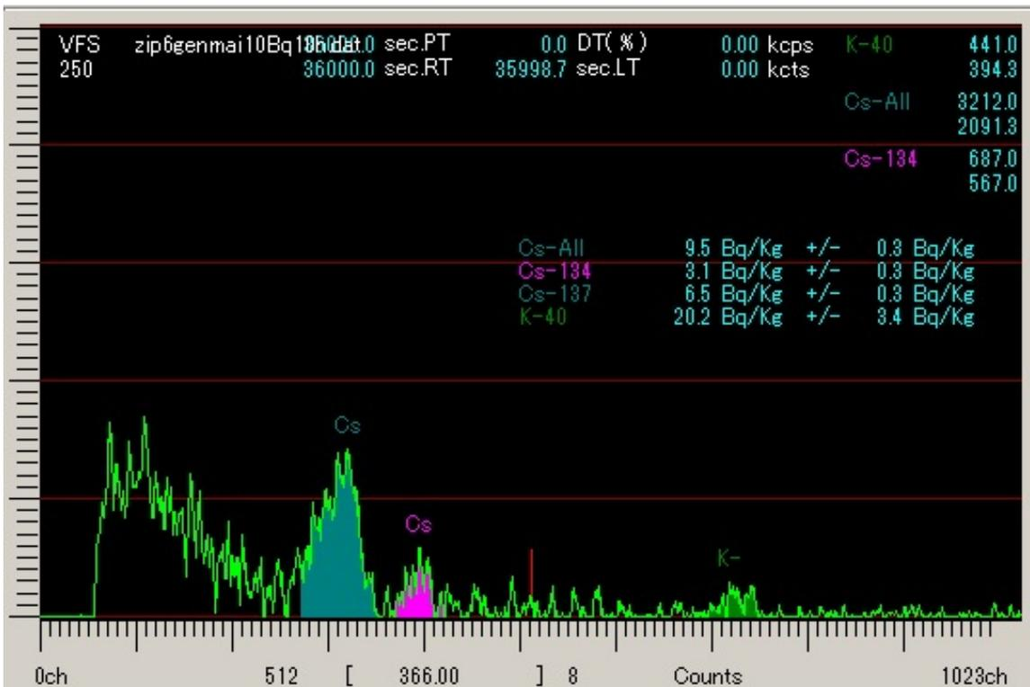
下記のスペクトルは、玄米を2Kchで10時間測定後、スムージング処理、さらに2Kchを1Kchに圧縮した物です。このままでは、赤いカーソルの部分がCs-137,4のピークですがバックグラウンド(以下BGと略)に埋もれて判別は困難です。
